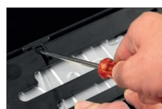
**5. Montaggio del telaio intercambiabile**
